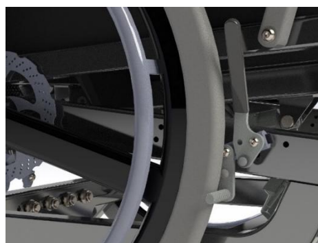
Cobi Cruise är utrustad med både handbromsar och skivbromsar.
