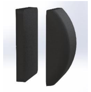
Varje modul i ryggkudden består av ett hårt skumlager och av ett lager med en blandning av Kröyerkulor och latexskum.
