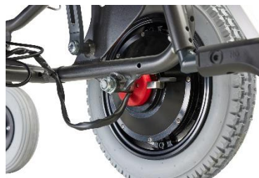
Det svarta frikopplingshandtaget skjuts upp (på båda hjulen) när de två motorerna ska kopplas ihop.
