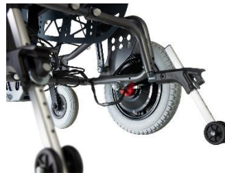
Påmonterad anti-tip som kan justeras efter terrängen.
