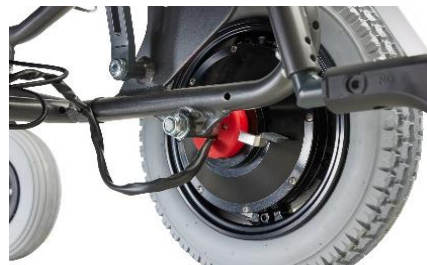
Det svarta frikopplingshandtaget trycks ned (på båda hjulen) vid behov av frångkoppling av de två motorerna.
