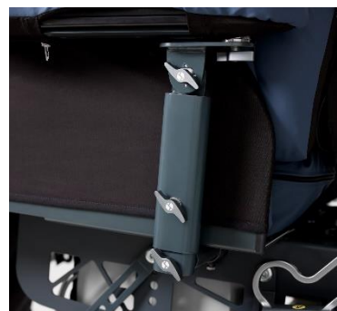
Armstöd med fyra fingervred på sidan. Den nedra skruven ser till så att armstödet kan tas bort. Skruven i mitten justerar höjden. Den två övre skruvarna vinklar armstödet upp.
