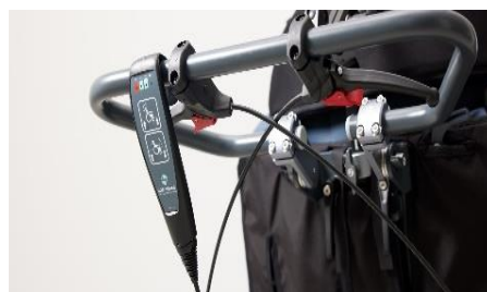
Bromsgreppen är monterade på körbygeln.
