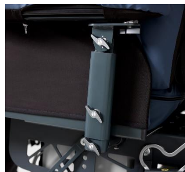
Armstöd med fyra fingervred på sidan. Den nedra skruven ser till så att armstödet kan tas bort. Skruven i mitten justerar höjden. Den två övre skruvarna vinklar armstödet upp.
