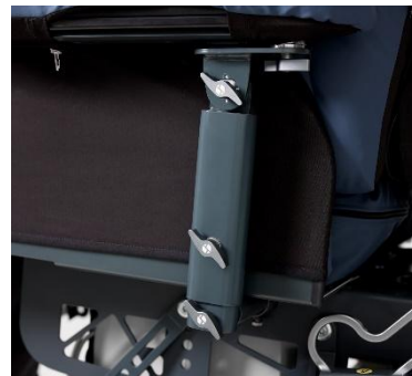
Armstöd med fyra fingervred på sidan. Den nedre skruven ser till så att armstödet kan tas bort. Skruven i mitten justerar höjden. Den två övre skruvarna vinklar armstödet upp och ner,
