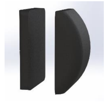
Var og en af de ni modulerna i ryggplattan består af ett hårt skumlager och ett lager med en blandning af Kröyer-kulor och latexskum.
